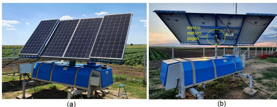
Slika 7: Izgled dvoosnog fotonaponskog mobilnog solarnog generatora (MSG); (a) izgled prednje strane, (b) izgled zadnje strane sa elektromotornim pogonom
